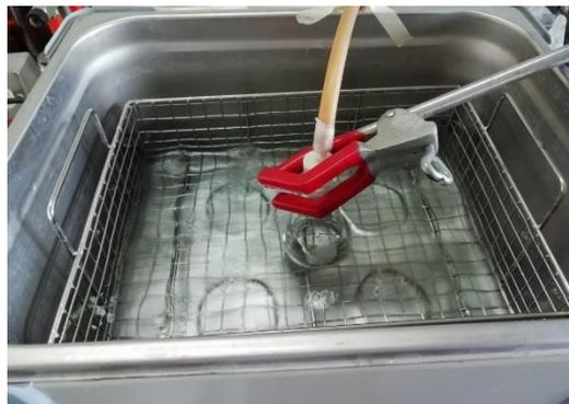
*Figura 11 Dispositivo para la preparación de rHDL*
